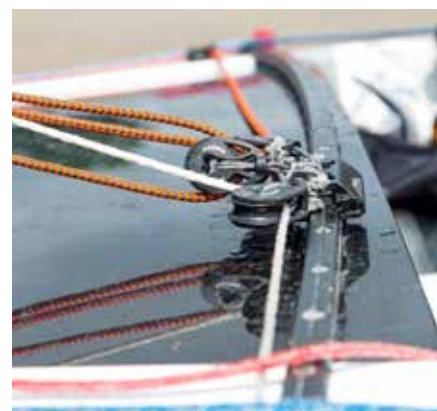
De fok is zelfkerend uitgevoerd.
